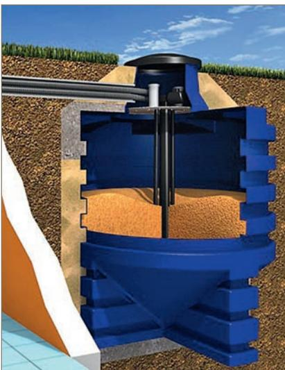
Fig. 18: Silo enterré en plastique avec vis sans fin verticale
