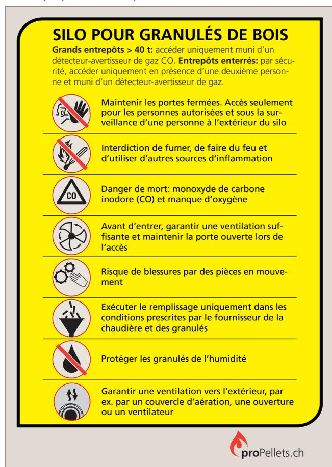
Fig. 32: Consignes de sécurité pour les locaux de stockage de pellets, les entrepôts préfabriqués praticables et imperméables à l'air ainsi que les locaux d'installation de grands entrepôts préfabriqués perméables à l'air.
